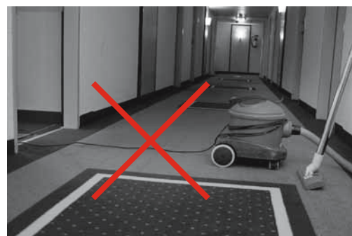
Bild 8: Quer durch Korridore führende Stromkabel bilden gefährliche Stolperstellen.
