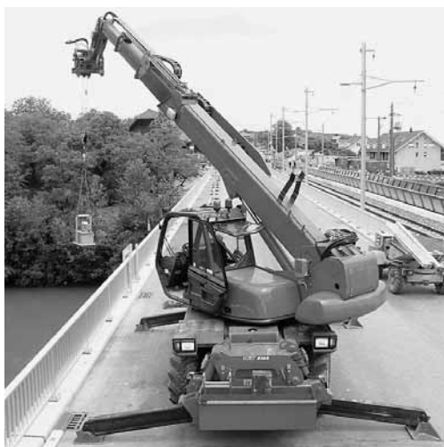
Foto 5 autogrù: sollevatore telescopico con argano
