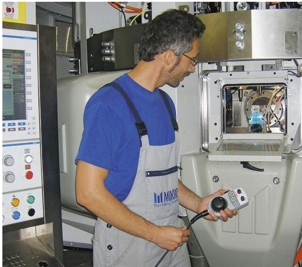
Terminal manuel avec dispositif de quittance à trois touches. Machine transfert rotative NRG-50 de la société Mikron SA à Agno (TI).
